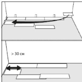
Для получения лучшего визуального эффекта рекомендуем располагать панели вдоль самой длинной стены и параллельно направлению падения света.
